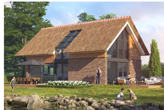
rietten kap, metselwerk begane grond, daarboven hout
